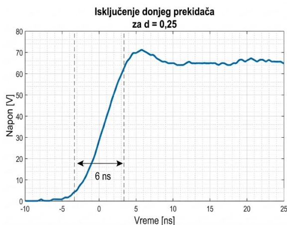
Slika 18. Promena napona v_{ds} prilikom isključenja donjeg prekidača
